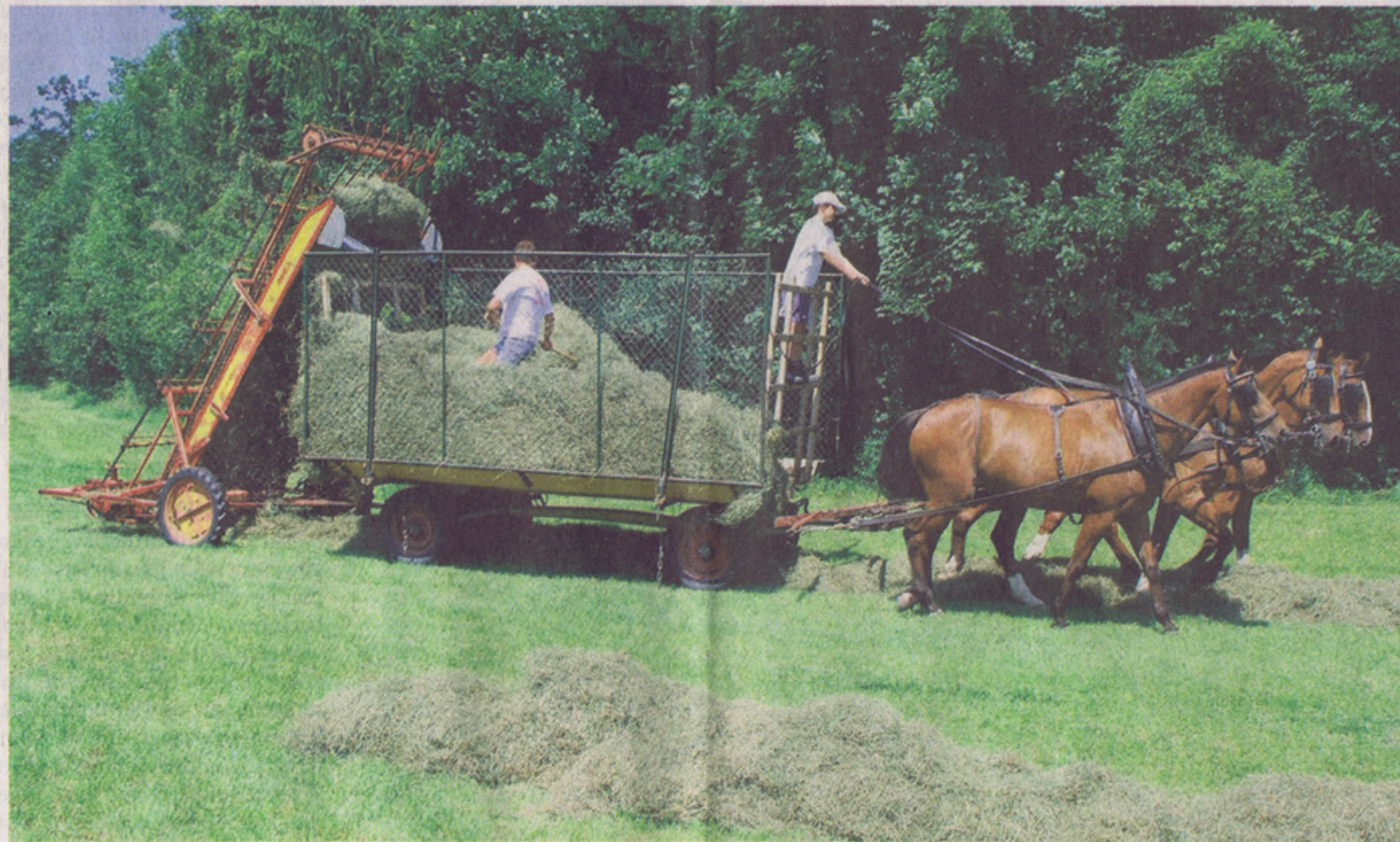
Ohne Motor: Die Pferde sorgen für den Antrieb und setzen durch die Bewegung den Heulader in Gang.
